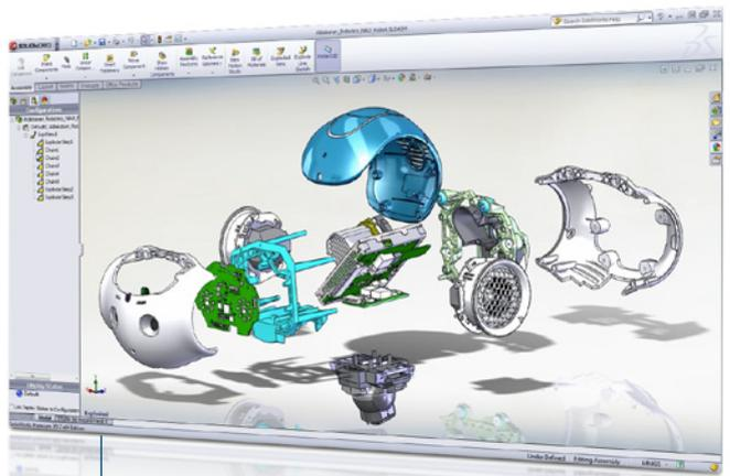
Aldebaran utiliza las herramientas integradas de SOLIDWORKS Simulation para optimizar el funcionamiento de las piezas, así como la producción de componentes mediante moldeo por inyección.
