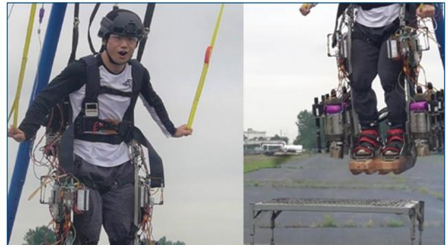
SOLIDWORKS Topology Optimization 연구를 통해 부품의 무게를 감량하고 SOLIDWORKS Flow Simulation 도구로 다리에 두 개씩 고정되는 네 개의 제트 엔진에 맞게 스트러트 벡터 노즐의 형태를 최적화한 Exovolar는 언제 끝날지 알 수 없는 프로토타입 제작 없이, 소프트웨어로 설계 성능을 시뮬레이션하고 설계를 최적화하여 첫 호버링 테스트를 성공적으로 마칠 수 있었습니다.
