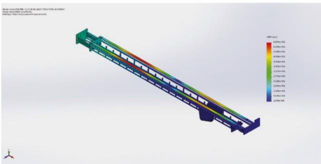
SOLIDWORKS Simulation Professionalを導入したことで、Paranthaman Exportersは、部品とアセンブリ両方のFEAスタディを実施してリグの性能を検証できます。この機能によって、機器の強度と性能を高めると同時に、リグの重量と材料の使用量および関連コストを減らせるようになりました。
