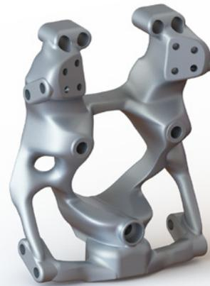
Giaffone Racingは、SOLIDWORKS Simulation Professionalトポロジー スタディ機能を使って、ストックカー ブラジル選手権向けの新しいコンポーネントを設計しています。最初に、サスペンションアップライト（ナックル）から取り掛かります（図を参照）。これは、車輪、ブレーキローター、ハブ、ブレーキ キャリパー、ステアリング アームを車体に固定するパーツです。
