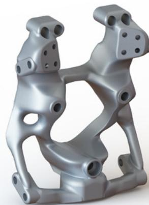
Grazie alle funzionalità dello studio topologico di SOLIDWORKS Simulation Professional, Giaffone Racing sta sviluppando nuovi componenti per le gare di stock car brasiliane, a partire dal montante della sospensione, o articolazione, qui mostrati, che collega la ruota, il rotore del freno, il mozzo, la pinza del freno e il braccio dello sterzo al veicolo.
